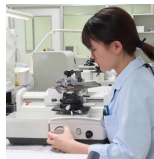
薄切（病理標本を作るための工程の1つ）の様子：ミクロトームという装置で厚さ3μm（0.003mm）に薄切された切片をスライドガラスにのせ、染色します。機械化の進む検査の中でも、病理標本作製は手作業で行う工程が多く、臨床検査技師の技能が必要とされます。
