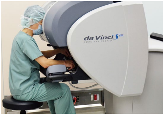
【図4】ダ・ヴィンチ手術は、執刀医が「サージョンコンソール」という機器でロボットアームを遠隔操作して行われる
